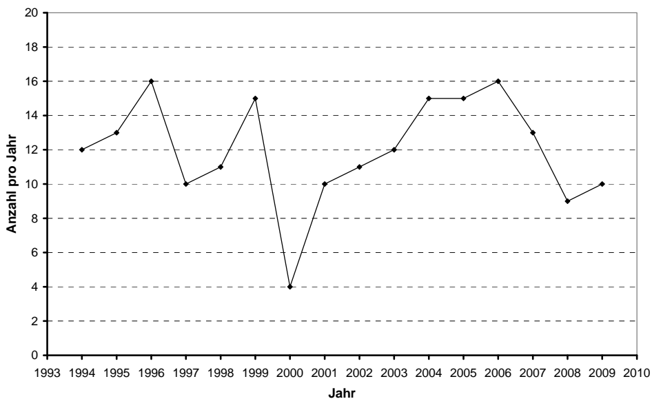
Abb. 6.4: Summe der in den Kernkraftwerken der SWR Baulinie 69 aufgetretenen meldepflichtigen Ereignisse (ME) verursacht durch Komponenten- und Bauteildefekte im Zeitraum 1994-2009.
