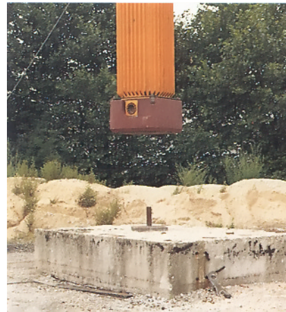
Abbildung 9: Fall auf einen Stahldorn
