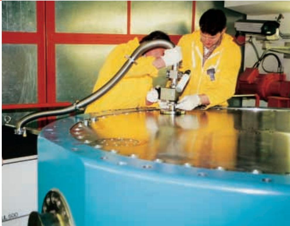
Dichtheitsprüfung am Castorbehälter V/19
