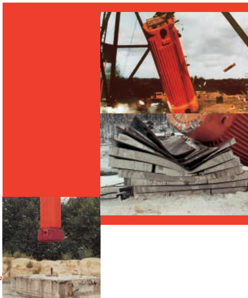
Fallversuch aus neun Meter Höhe auf ein unnachgiebiges Fundament.
