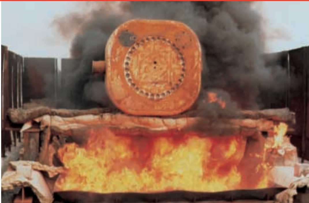
Feuertest bei einer Flammentemperatur von 800°C
