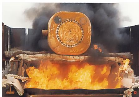
Diese Härtetests decken alle denkbaren Belastungen im BELLA infolge von mechanischen Einwirkungen durch Absturz oder Anprall eines Behälters sowie die Einwirkung durch einen Brand sicher ab. Darüber hinaus wurde wiederholt nachgewiesen, daß die Behälter noch weitaus stärkere Belastungen unbeschadet überstehen.
