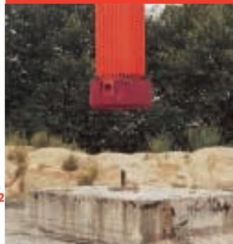
Die im Zwischenlager am Kernkraftwerk Brokdorf eingelagerten Behälter werden sowohl für die Aufbewahrung als auch für den Transport der Brennelemente verwendet. Für diese Behälter muss somit die verkehrsrechtliche Zulassung als Typ B(U)-Versandstückmuster für den Transport auf öffentlichen Verkehrswegen vorliegen. Hierfür wurde nachgewiesen, dass die Typ B(U)-Versandstücke u. a. den kumulierten Belastungen aus folgenden Prüfungen standhalten:
